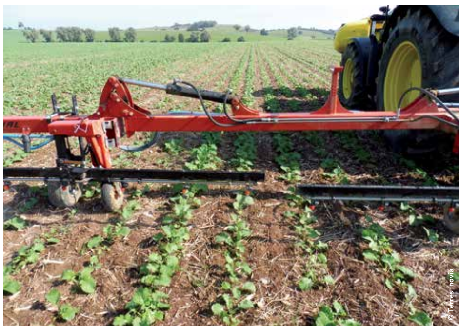
Dans les essais, le désherbage localisé sur le rang en post-levée a été réalisé avec une rampe Maréchal.
