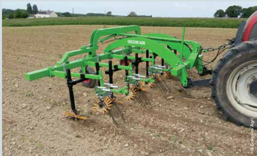
Installé à l'avant du tracteur, le Désherb'rang de Grégoire Agri élimine les adventices sur le rang avec précision, sans besoin d'une assistance de guidage.
